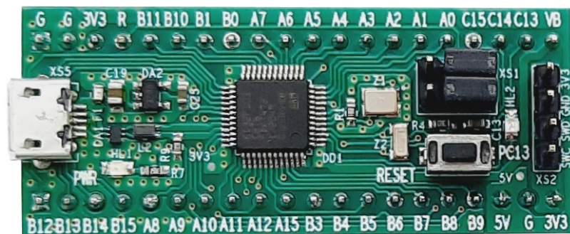
Рисунок 3: Настройка модуля на загрузку программы из Flash-памяти
