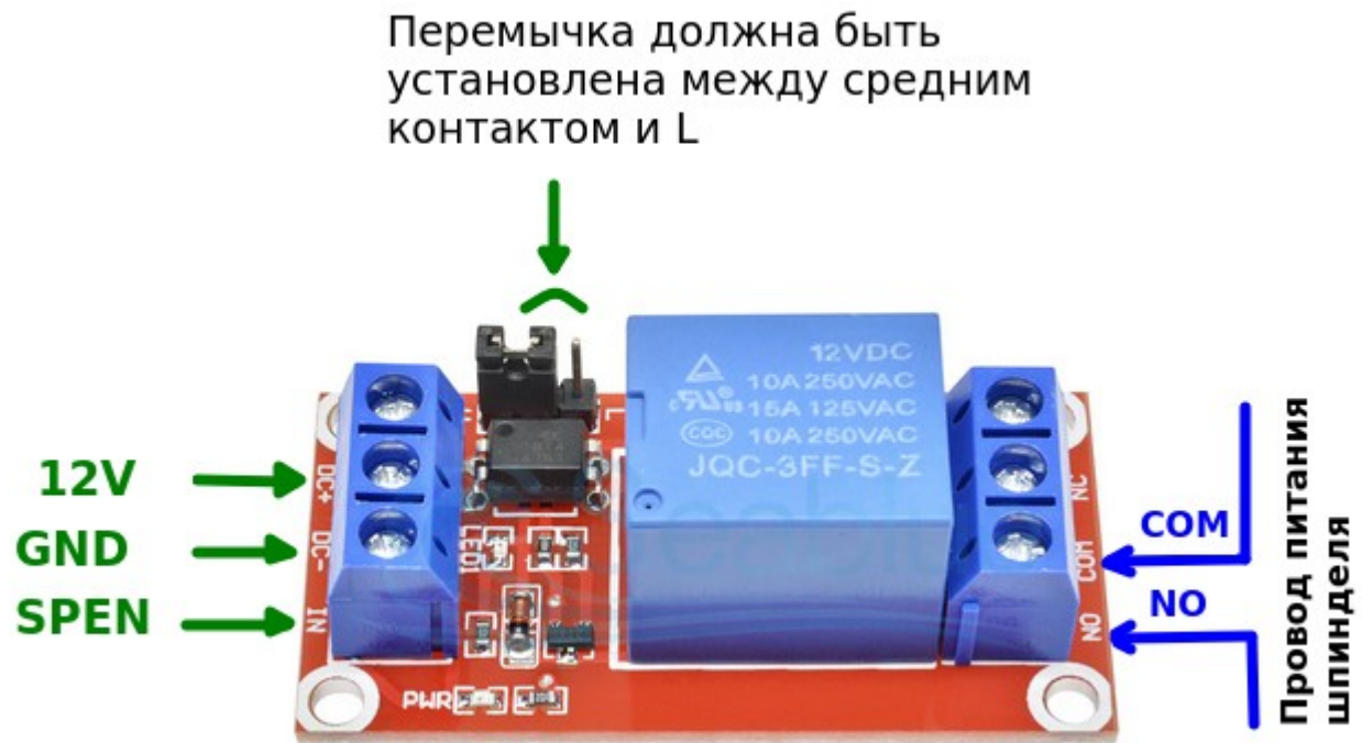
Рисунок 9: Подключение релейного модуля
