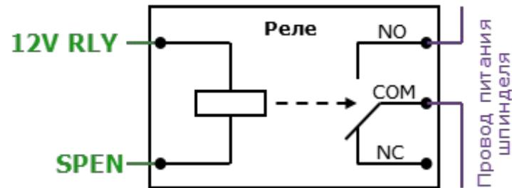
Рисунок 6: Подключение реле управления шпинделем
