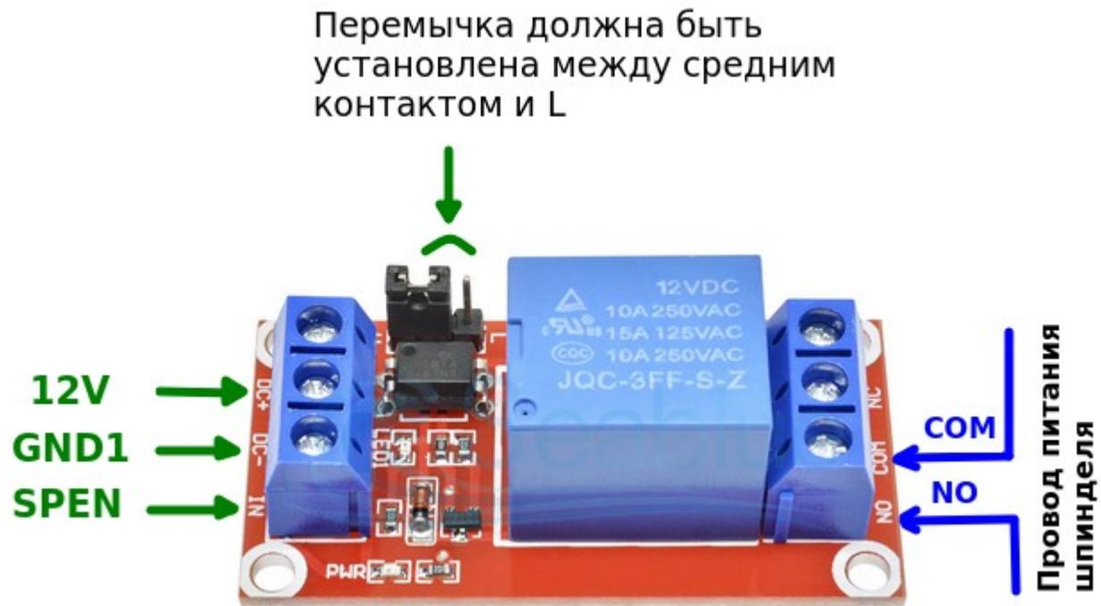
Рисунок 7: Подключение релейного модуля
