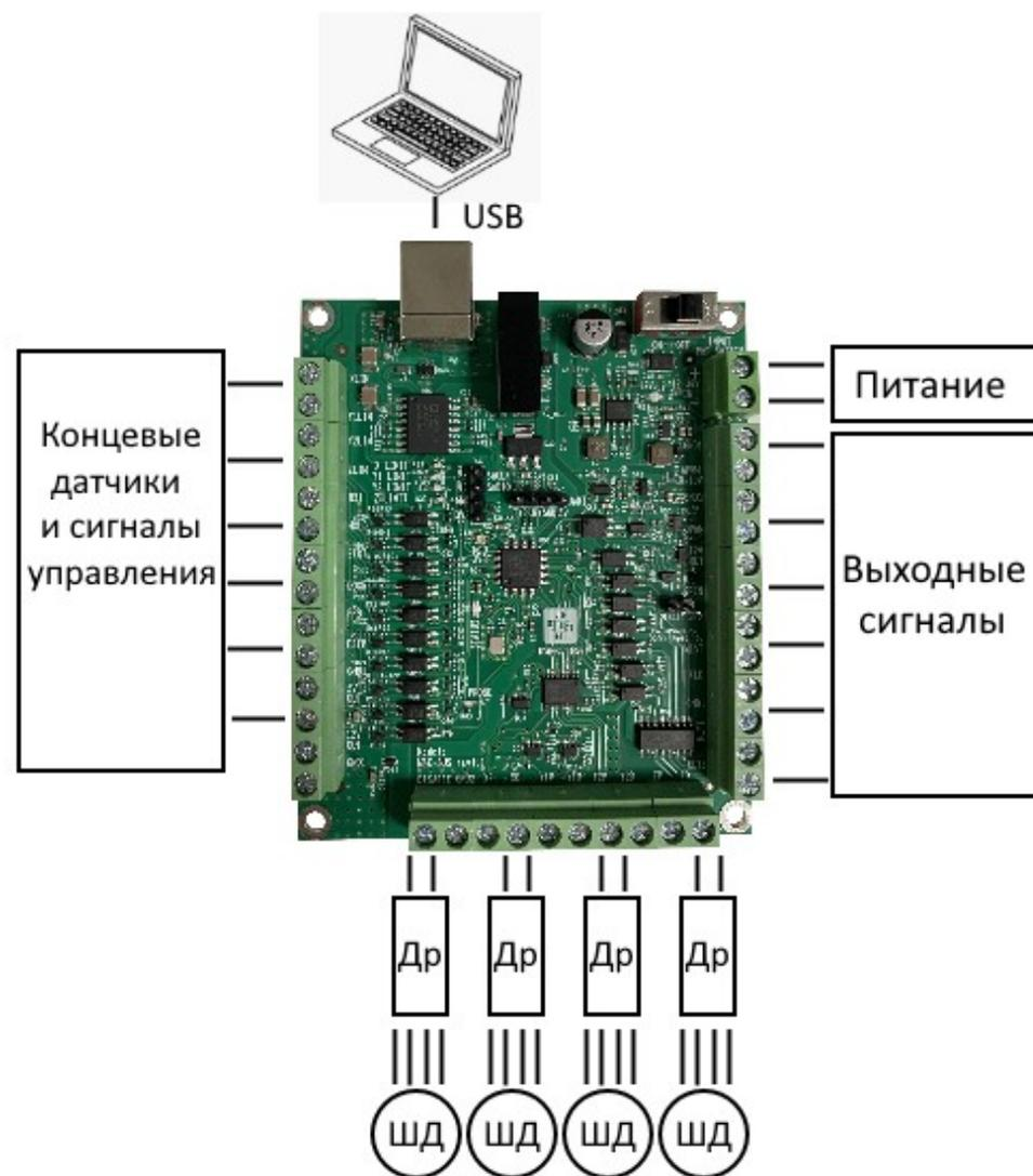
Рисунок 1: Упрощенная схема подключения контроллера MSC-3US
