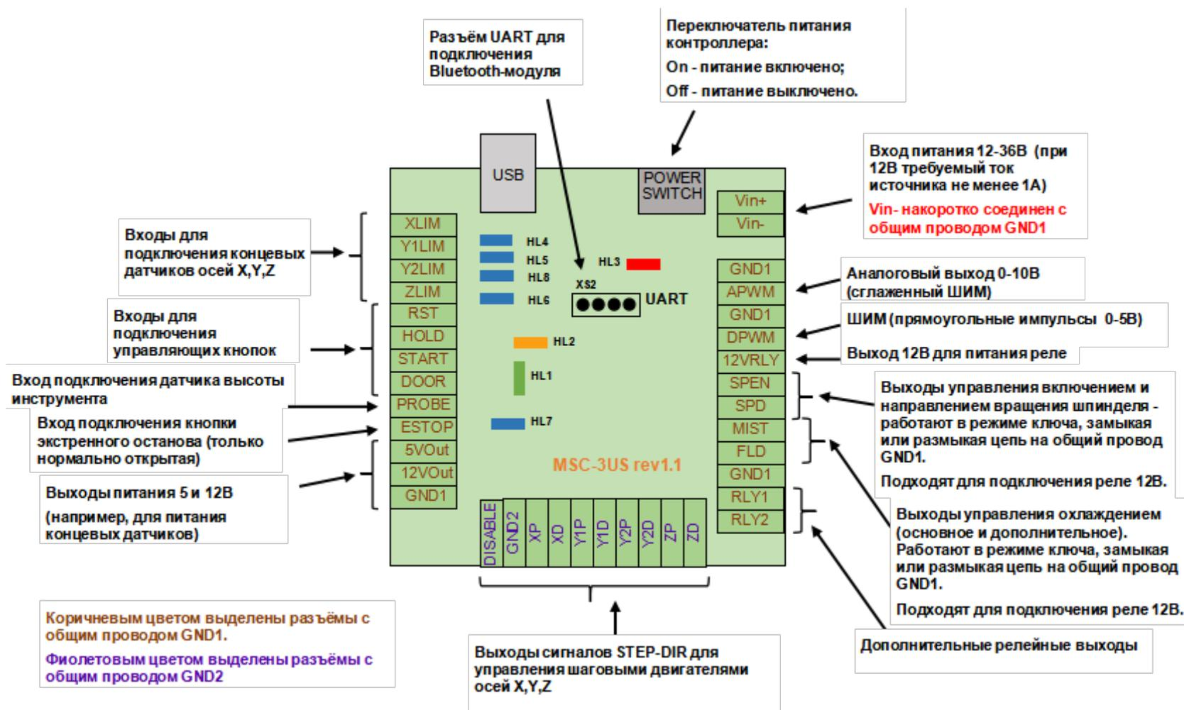
Рисунок 3: Структурная схема контроллера MSC-3US
