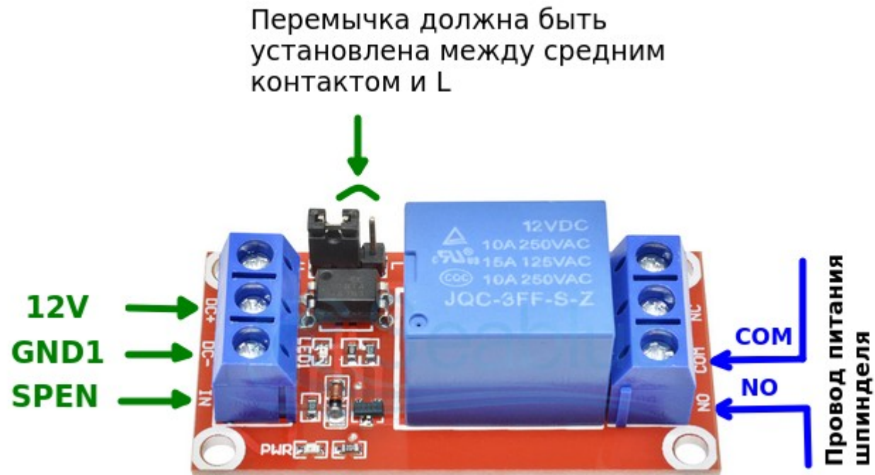
Рисунок 8: Подключение релейного модуля
