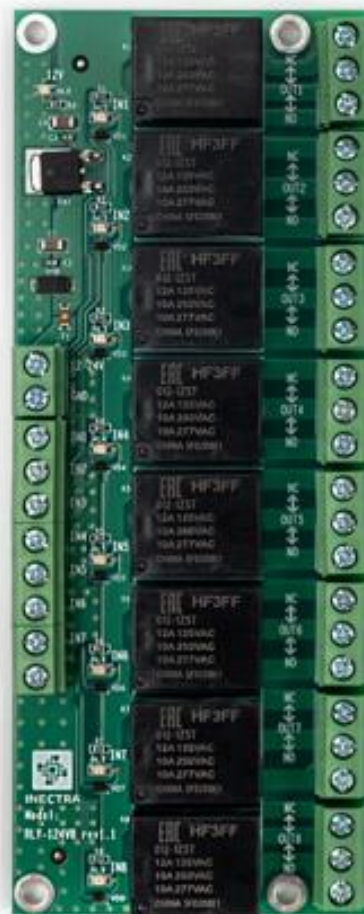
Рисунок 2 – Внешний вид платы модуля реле RLY-124V8
